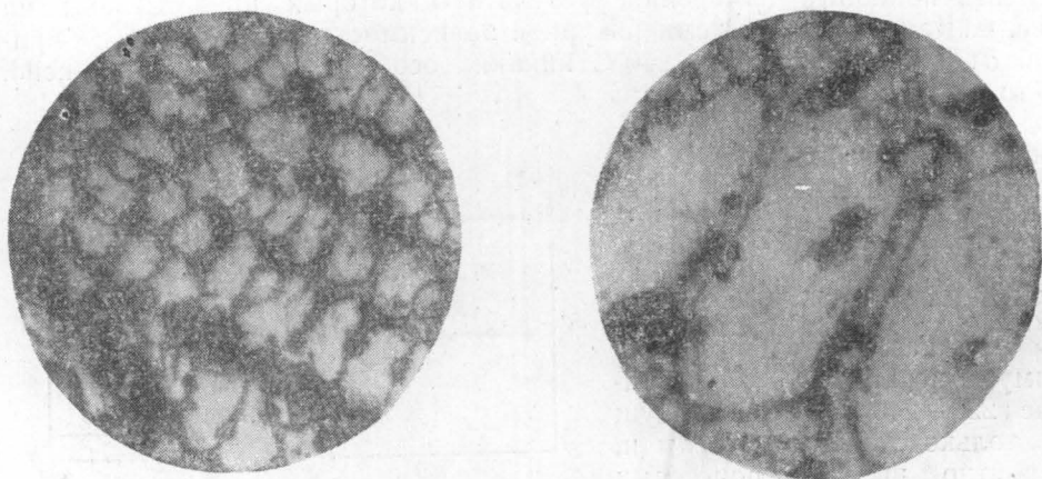
Рис. 6. Микроструктура сплава с 27 ат. % В: слева— \times 134 , справа— \times 596
