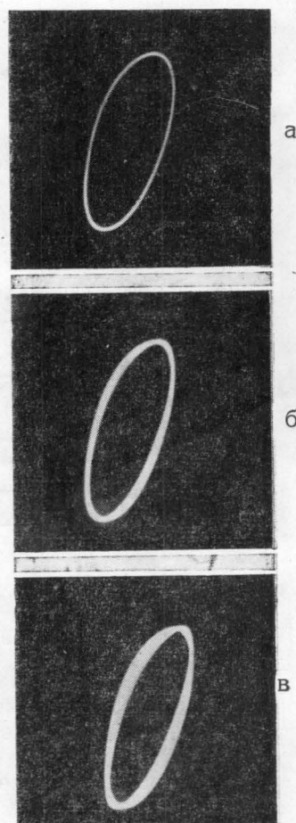
Рис. 7. Осциллограммы, иллюстрирующие зависимость разрешающей способности \Delta\Phi_{\text{мин}} фазометра для некогерентных сигналов от \tau при \Delta f=1610 гц, а — \tau=10 мксек, б — \tau=60 мксек, в — \tau=100 мксек
