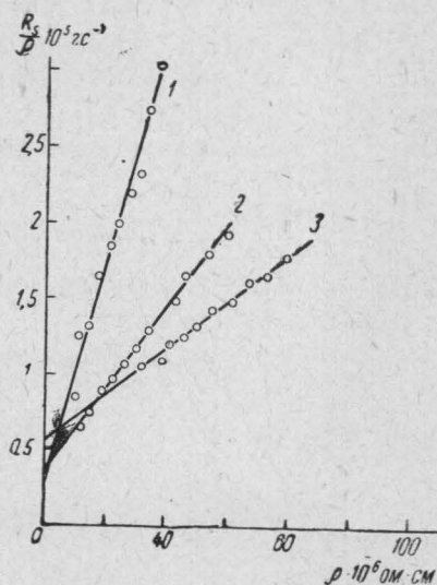
Рис. 4. Связь между величинами \frac{R_s}{\rho} и \rho у сплавов Fe—Cd с содержанием Gd: 1—1%, 2—3%, 3—5%
