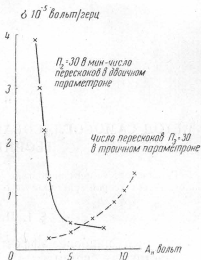
Рис. 7. Среднее число перескоков фазы \Pi = 30 в мин. для различных значений среднеквадратичного шумового напряжения \sigma в контуре параметрона в зависимости от напряжения накачки A_n
