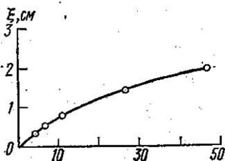
Рис. 3. Ход во времени  $t$  оплавления и затвердевания  $\xi$  стальных изделий
