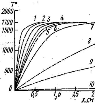
Рис. 1. Остывание затвердевшего материала.  $T_{\text{распл}} = 1700^\circ\text{C}$ , температура холодильника  $T_0 = 0^\circ\text{C}$ : 1—0,1; 2—0,2; 3—0,4; 4—0,6; 5—0,8; 6—1,0; 7—2,0; 8—16; 9—60; 10—900
