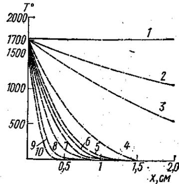
Рис. 2. Прогревание твердого материала печью:  $T_{\text{печь}} = 1700^\circ\text{C}$ . Обозначения те же, что на рис. 1
