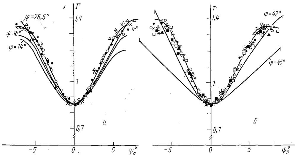
Рис. 3. Зависимости  $\Gamma(\psi_p)$  в случае бомбардировки мишени под небольшими углами к плоскости (100) для разных углов падения  $\varphi$ ; значения  $\varphi$ , принадлежащие трем диапазонам углов (см. текст), составляют: *a*— $18^\circ$  (O),  $20^\circ$  (●),  $22^\circ$  (X) и  $24^\circ$  ( $\Delta$ ); *b*— $30^\circ$  (●),  $32^\circ$  (X),  $34^\circ$  (O),  $36^\circ$  ( $\Delta$ ),  $38^\circ$  ( $\square$ ),  $54^\circ$  ( $\nabla$ ) и  $59^\circ$  (\*).
