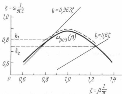
Рис. 2. Зависимость резонансной частоты  $\omega_{рез}$  от продольного волнового числа  $\beta$  в координатах  $(\zeta, \xi)$ , полученная при параметрах структуры  $l=1,5$  см,  $d=1,0$  см,  $h=0,3$  см. Пунктиром показана дисперсионная характеристика моды  $E_{01}$  диафрагмированного волновода
