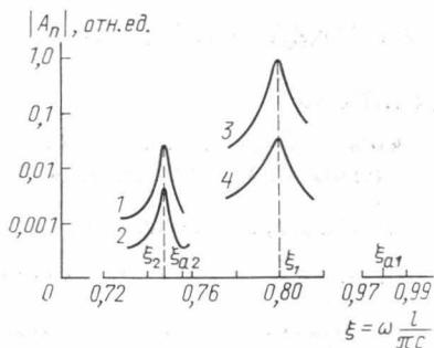
Рис. 3. Зависимость модуля амплитуд дифракционных гармоник от приведенной частоты  $\xi$  для двух значений скорости  $v_0$ : 1 и 2 — соответственно 1-я и нулевая гармоники при  $v_0=0,6$  с; 3 — нулевая гармоника при  $v_0=0,967$  с, 4 — 1-я гармоника при  $v_0=0,967$  с,  $\xi_{a1}$  и  $\xi_{a2}$  — приведенные частоты, соответствующие аномалиям Вуда для двух значений скорости  $v_0$
