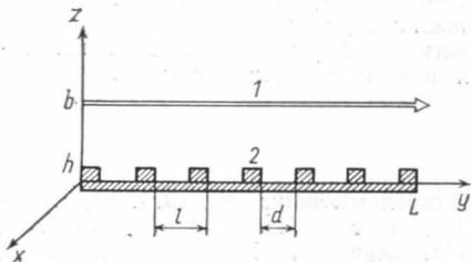
Рис. 1. Общий вид рассматриваемой системы: 1 — электронный поток, 2 — периодическая структура (дифракционная решетка)
