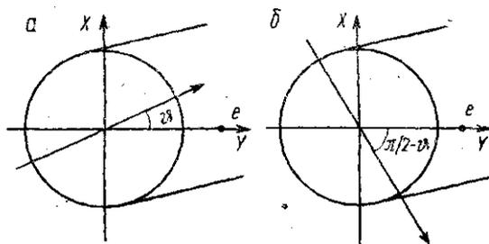
Рис. 1. Возможная поляризация поля в волноводе в начале (а) и в конце (б) взаимодействия с электроном (схема (а) с одним волноводом)
