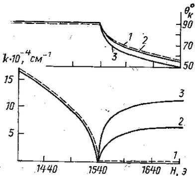
Рис. 2. Зависимость  $k$  и  $\theta_k$  от  $H$  при  $h \parallel H$ . Штриховые кривые (1) — результат обычной минимизации, сплошные — расчет по формуле (1);  $L=1,02$  (2) и  $0,18$  мм (3)
