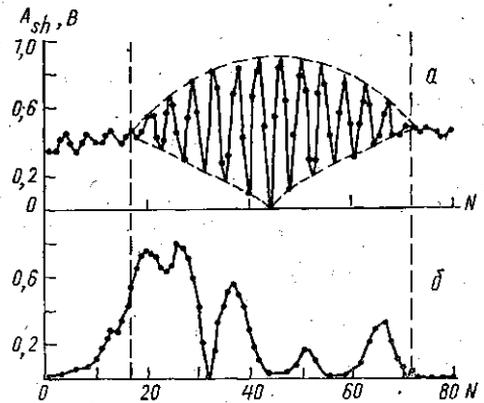
Рис. 5. Зависимость амплитуды субгармоники  $A_{sh}$  от номера ячейки  $N$ : малые потери (а) и большие потери (б). Вертикальными пунктирными линиями отмечены границы области взаимодействия с накачкой. На рис. 5, б тонкая структура распределения не показана
