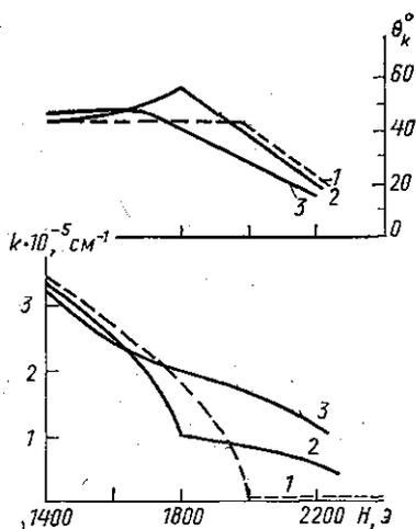
Рис. 4. Зависимость  $k$  и  $\theta_k$  от  $H$  при  $h \perp H$ . Штриховая кривая (1) — результат обычной минимизации, сплошные — расчет по формуле (1);  $L=1,3$  (2) и  $0,18$  мм (3).
