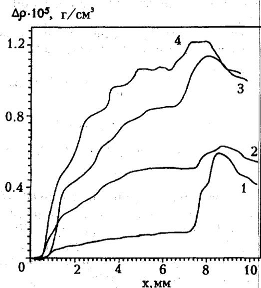
Рис. 3. Распределение плотности в аргоне при различных числах Маха:  $M = 2,42$  (1); 3 (2); 3,25 (3) и 3,4 (4)
