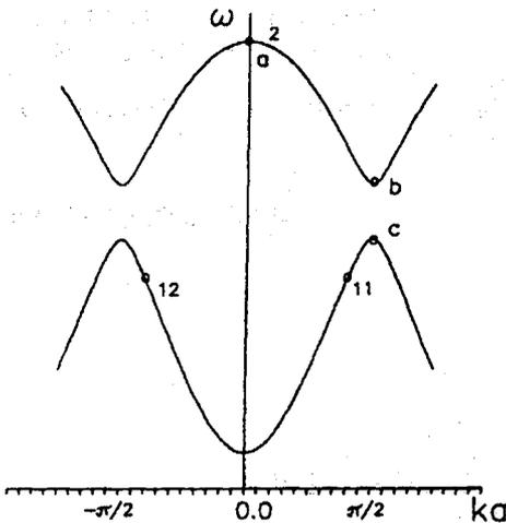
Рис. 1. Дисперсионная кривая для системы чередующихся связанных колебательных систем. Две волны основной частоты 11 и 12 с противоположно направленными волновыми векторами возбуждают неподвижную стоячую волну 2 удвоенной частоты
