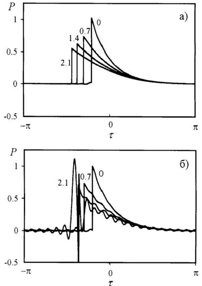
Рис. 2. Эволюция профиля однополярного ударного импульса сжатия в нелинейной среде, рассчитанная с учетом двух асимптотик: «пилообразная» и «параболическая» (а) и асимптотики только пилообразной волны (б), на различных расстояниях  $z$  (цифры у кривых)
