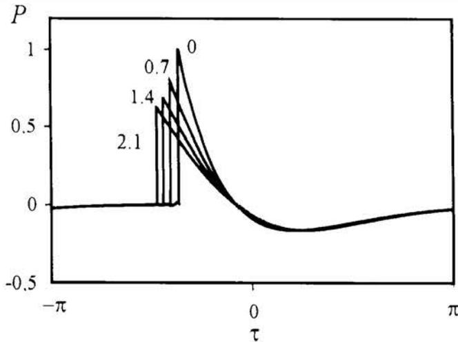
Рис. 3. Эволюция профиля двухполярного ударного импульса в нелинейной среде, рассчитанная с учетом двух асимптотик: «пилю» и «параболы» на различных расстояниях  $z$  (цифры у кривых)
