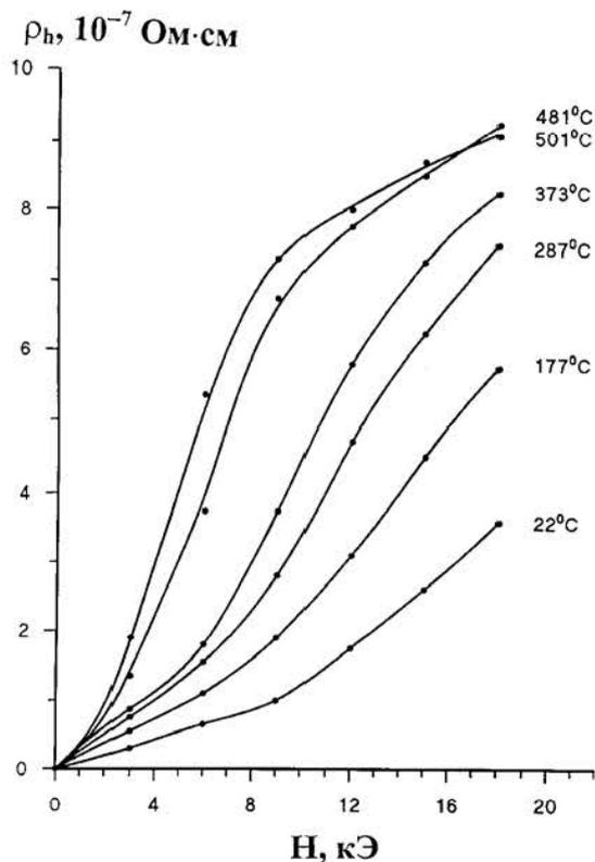
Рис. 3. Зависимость удельного холловского сопротивления  $\rho_h$  сплава  $\epsilon'$ -Mn<sub>3</sub>Ga от магнитного поля при некоторых температурах
