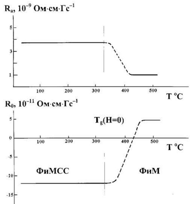
Рис. 5. Зависимость от температуры коэффициентов  $R_a$  (АЭХ) и  $R_0$  (НЭХ) сплава  $\epsilon'$ - $Mn_3Ga$ . Отмечено значение температуры перехода ( $T_g = 325$  °С при  $H = 0$ ) из состояния ферромагнитного спинового стекла (ФимСС) в ферромагнитное состояние (Фим)
