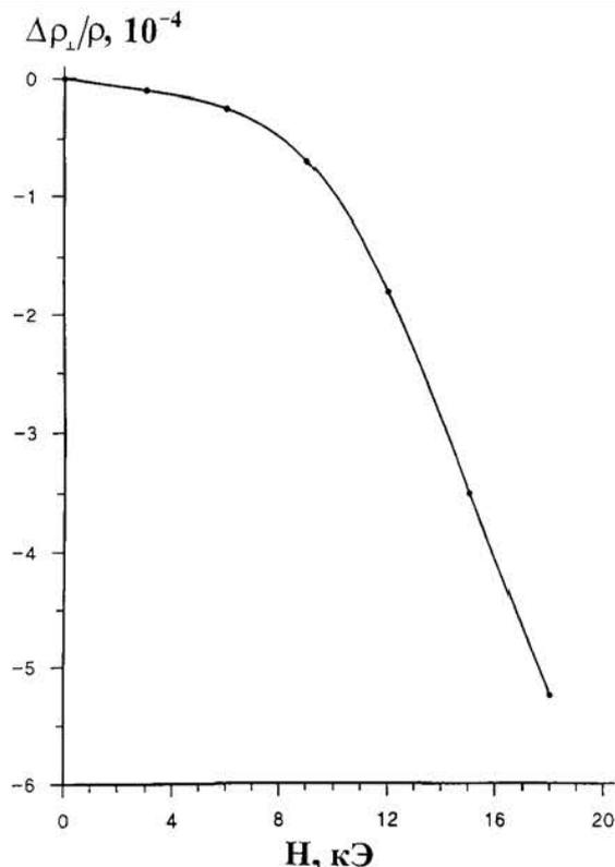
Рис. 2. Зависимость поперечного магнетосопротивления  $\Delta\rho_{\perp}/\rho$  сплава  $\epsilon'$ -Mn<sub>3</sub>Ga от магнитного поля  $H$  при  $20^\circ\text{C}$
