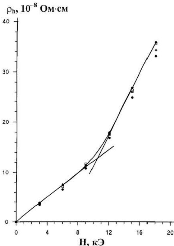
Рис. 1. Зависимость удельного холловского сопротивления  $\rho_h$  сплава  $\epsilon'$ -Mn<sub>3</sub>Ga от магнитного поля при  $T = 20^\circ\text{C}$ : исходное состояние (●), после охлаждения от  $T = 118^\circ\text{C}$  (□),  $287^\circ\text{C}$  (△) и  $395^\circ\text{C}$  (○)
