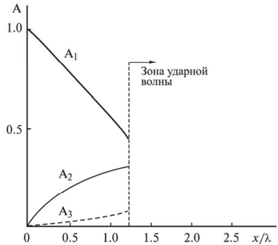
Рис. 3. Расчет спектра матричных волн по формуле (22) при условии  $a > 1$ ,  $Da = 0,1$  на различных расстояниях  $x$  от источника. Порог  $a = 1$  превышен, и ударные пилообразные волны сформировались на расстоянии  $x_c = 1,276\lambda$
