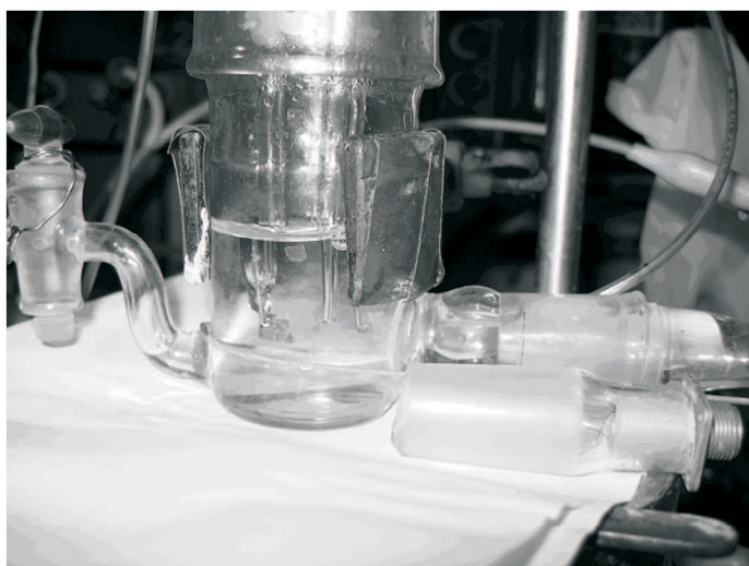
Рис. 2. Фотография электрохимической ячейки с ПКР, вклеенным в шлиф
