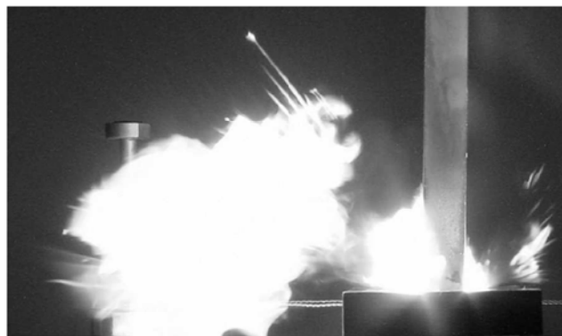
Рис. 3. Горение бензина, воспламененного в условиях поверхностного СВЧ-разряда при p = 1 атм, W = 55 кВт, \tau = 100 мкс. Время экспозиции 1 с
