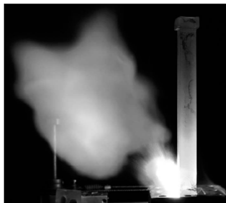
Рис. 1. Интегральный снимок процесса воспламенения и горения чистого спирта в условиях поверхностного СВЧ-разряда. Условия эксперимента: давление воздуха 1 атм, длительность СВЧ-импульса 100 мкс, импульсная СВЧ-мощность 55 кВт
