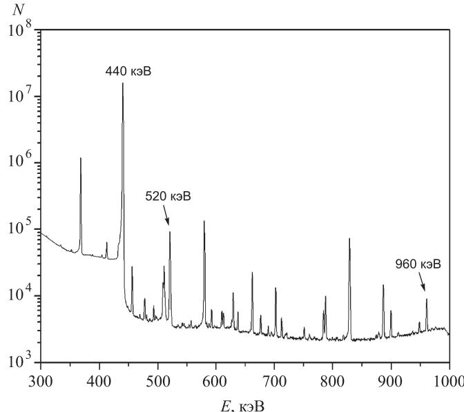
Фрагмент  $\gamma$ -спектра, содержащий  $\gamma$ -переходы  $^{202}\text{Tl}$ .
