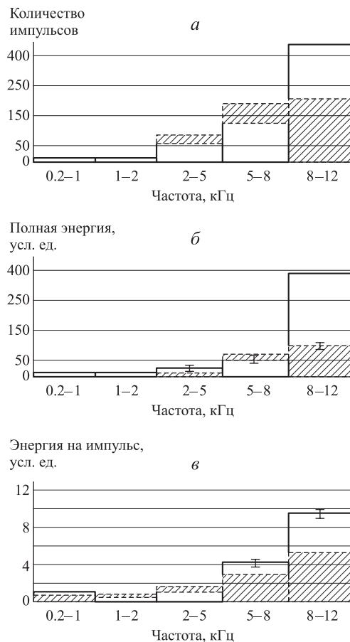
Рис. 4. Сравнительные статистические характеристики фоновых импульсов ГАЭ (штриховая линия) и в период проявления аномалии (сплошная линия без заполнения) для пяти частотных полос: *а* — суммарное количество импульсов геоакустической эмиссии, зарегистрированное за одинаковый временной интервал; *б* — интегральная энергия сигналов геоакустической эмиссии за этот же промежуток времени; *в* — средняя энергия, приходящаяся на один импульс
