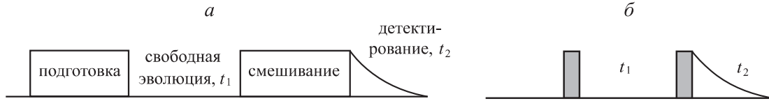
Рис. 2. Общая схема последовательностей двумерной спектроскопии (а); импульсная последовательность COSY (б)
