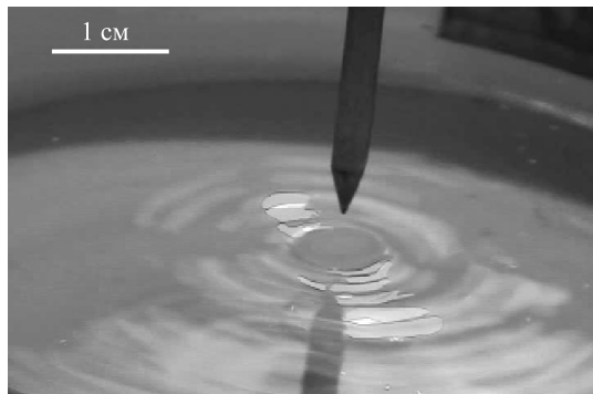
Рис. 2. Появление воронки на водной поверхности. Пластмассовая кювета, расстояние между верхним электродом и поверхностью жидкости 5 мм. Отрицательная корона
