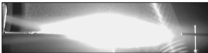
Рис. 1. Интегральная (без временного разрешения) фотография зоны горения спирта в дозвуковом потоке в условиях программированного импульса
