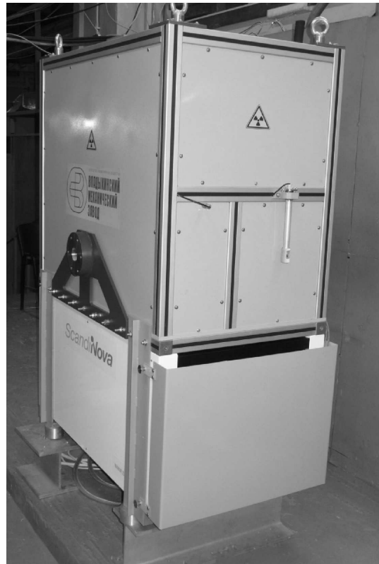
Рис. 9. Линейный ускоритель для радиационной дефектоскопии УЭЛР-8-2Д
