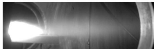
Рис. 1. Стабилизация внешнего горения дозвукового пропан-воздушного потока в условиях комбинированного разряда
