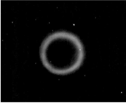
Рис. 1. Пространственная структура излучения СПР с кристалла ВВО при взаимодействии 1-го типа
