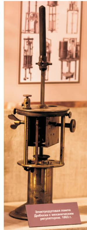
Рис. 2. Электромагнитный регулятор Ж. Дюбоска [44, с. 8], [45] (фото В. Зинакова)
