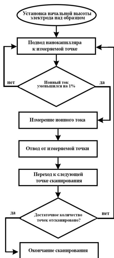
Рис. 2. Блок-схема принципа работы hopping mode
