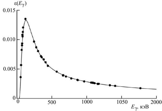
Рис. 1. Пример зависимости эффективности  $\epsilon(E_\gamma, l)$  регистрации HPGe-детектора от энергии  $\gamma$ -квантов  $E_\gamma$  при промежутке  $l = 10$  см между мишенью и торцом корпуса детектора. Кружки — результаты измерений с образцовыми стандартными  $\gamma$ -источниками, сплошная линия — результат расчёта с использованием GEANT4 [10]
