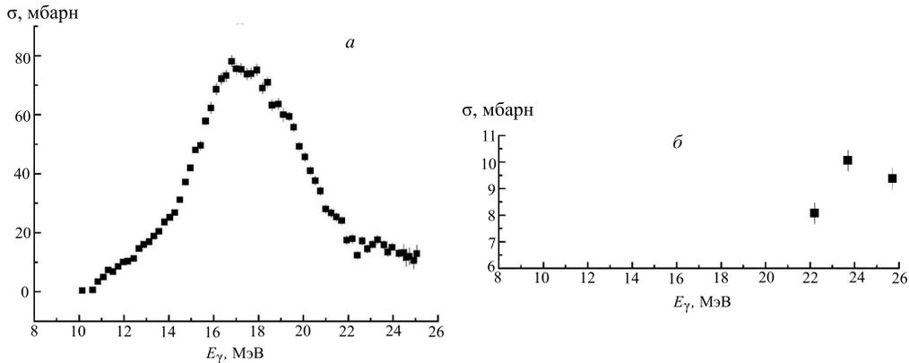
Рис. 3. Сечения реакций  $(\gamma, n)$  и  $(\gamma, 2n)$  в зависимости от энергии падающих  $\gamma$ -квантов  $E_\gamma$ : *a* —  $^{63}\text{Cu}(\gamma, n)^{62}\text{Cu}$  [6]; *б* —  $^{63}\text{Cu}(\gamma, 2n)^{61}\text{Cu}$  [6]
