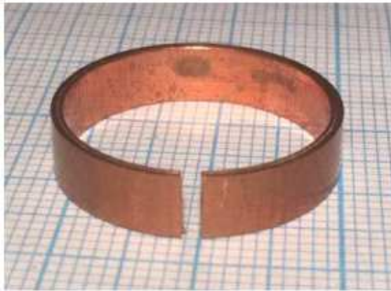
Рис. 2. Реальный резонатор в ГГц-диапазоне (а) и схематичное изображение модели резонатора с учетом конечной высоты метаатома (б)
