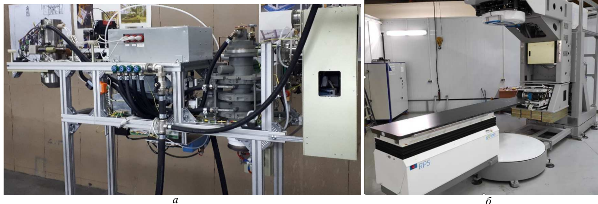
Рис. 1. а — Стенд для испытаний ускорителя электронов для лучевой терапии. б — Ускоритель электронов, установленный в гантри
