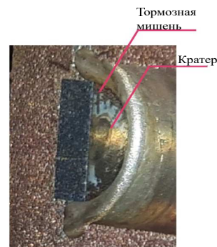
Рис. 11. Разрез опытной ускоряющей структуры в области тормозной мишени. Диаметр тормозной мишени из вольфрама 6 мм, диаметр кратера от пучка около 1 мм
