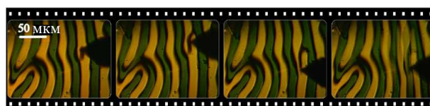
Рис. 9. Трансформация доменной структуры под воздействием электрически заряженного зонда кантилевера [33]. Изображения сделаны в отсутствие внешнего магнитного поля, электрическое напряжение между зондом и подложкой составляет 500 В. Использован образец 4 из таблицы
