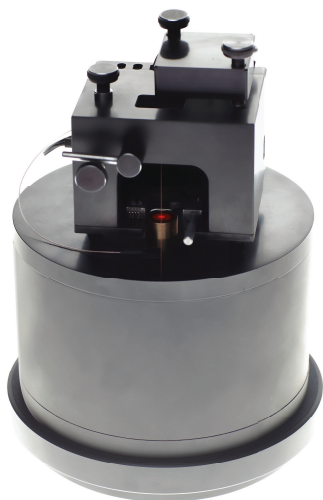
Рис. 8. Механическая система атомно-силового микроскопа. Три основные части: измерительная головка с кантилевером, лазером и фотодиодом, основание с прецизионным сканером, пассивная виброзащитная подставка
