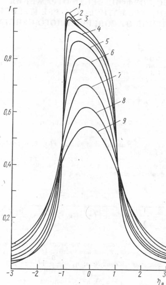
Кривые коэффициента отражения  $CoK_\alpha$  излучения от плоскости (220) Ge для различных значений относительной ширины спектра первичного излучения. 1 —  $\Gamma=0$ , 2 —  $\Gamma=0,001$ , 3 —  $\Gamma=0,01$ , 4 —  $\Gamma=0,05$ , 5 —  $\Gamma=0,1$ , 6 —  $\Gamma=0,2$ , 7 —  $\Gamma=0,4$ , 8 —  $\Gamma=0,6$ , 9 —  $\Gamma=0,8$
